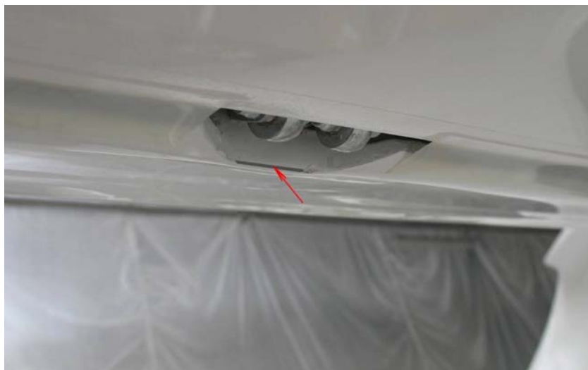
Bild A: Inspektionsbereich: Anlenkpunkt der Trimtab Steuerung am Trimtab (Blickrichtung unter dem Höhenleitwerk)
