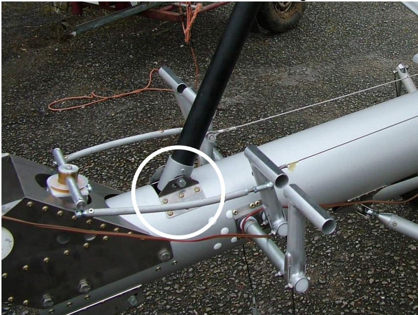
Abbildung 1: A-Säulenbefestigung an der Oberseite des Rumpfrohres. Untere Befestigungsschraube unter Hauptrumpfrohr sichtbar und am hinteren Ende der Halterung am Bugradträger befestigt.
