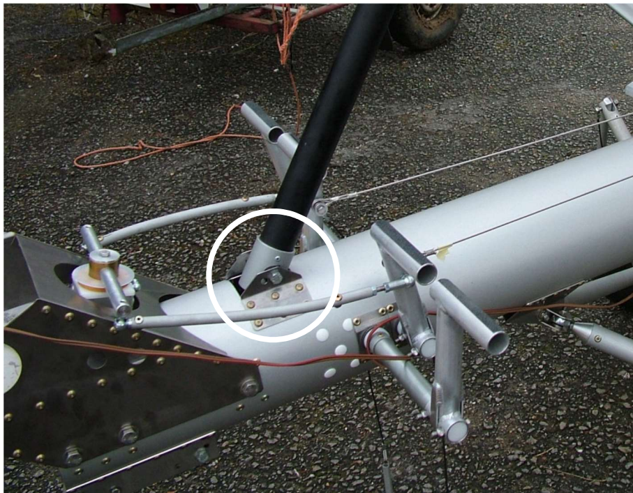
Abbildung 1: A-Säulenbefestigung an der Oberseite des Rumpfrohres. Untere Befestigungsschraube unter Hauptrumpfrohr sichtbar und am hinteren Ende der Halterung am Bugradträger befestigt.
