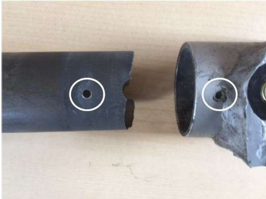
Abbildung 2: Gerissene A-Säule vom äußeren Hülsenteil (rechts im Bild) entfernt. Eingezeichnete Löcher zeigen die Position des Niets, der die Teile in axialer Position gehalten hat.
