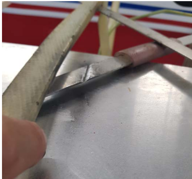
Bild 1: Diagonalverspannung unterhalb der Tanks, von unten gesehen (ohne Bespannung)
