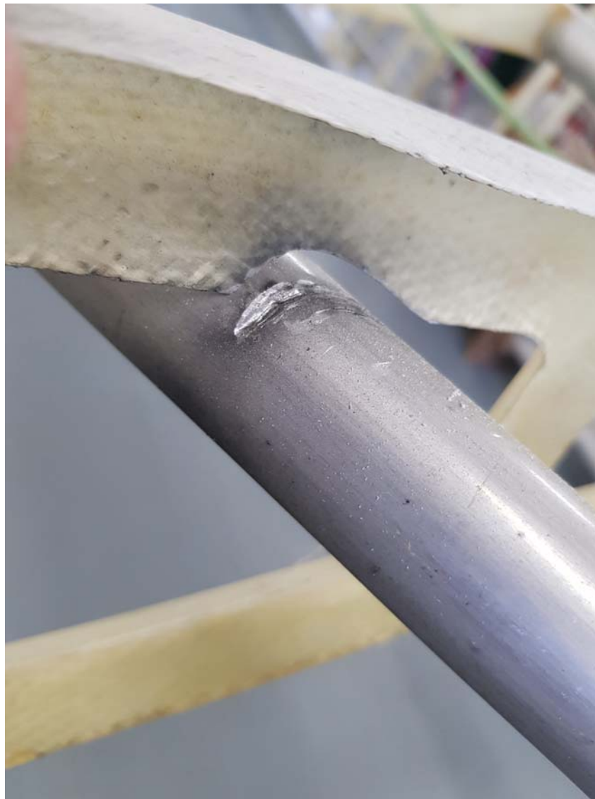
Bild 5: Diagonal Flügelstrebe / Rippe 3
