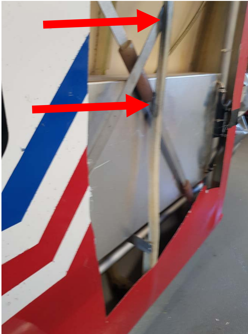
Bild 2: Diagonalverspannung unterhalb der Tanks, von unten gesehen (ohne Bespannung)
